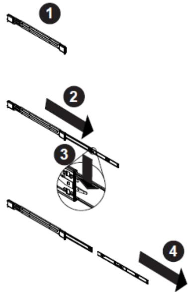
取り外した「Inner Rail」をシャーシの背面側から前面側にスライドさせロックをした後、短い皿ネジを使用し、ドライバーで左右に1箇所ずつ取りつけます。
