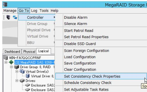
Stop Consistency Check on Error … 検査中にエラーが発見された場合、検査を中止します。
