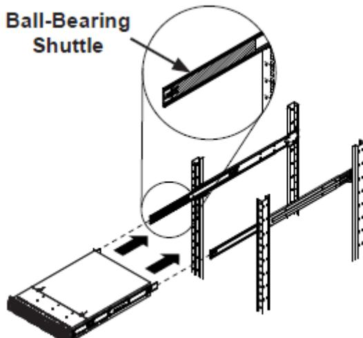
シャーシに取り付けてある「Inner Rail」を「Middle Rail」に左右同じ力で入れていき、「Inner Rail」の「Rocking Tab」がロックされる位置まで押し込みます。
