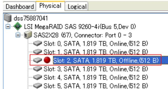
障害ディスクのドライブキャリア LED (左側) が赤点灯するので、対象ディスクの確認が可能ですが、LED が点灯しない等で判断できない場合は、MSM 画面で障害ディスクを選択した状態で右クリックし「Start Locating Drive」を実行すると、障害ディスクが赤点滅するので対象ディスクを特定できます。確認後は「Stop Locating Drive」で停止させてください。
