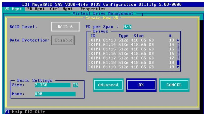
設定が全て終わったら [OK] を選択して、RAID 構成を実行させます。
