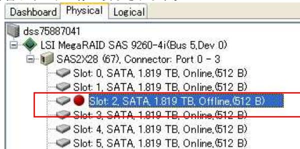
障害ディスクのドライブキャリア LED (下側) は赤点灯するので、対象ディスクの確認が可能ですが、LED が点灯しない等で判断できない場合は、障害ディスクを選択した状態で右クリックし「Start Locating Drive」を実行すると、障害ディスクが赤点滅するので対象ディスクを特定できます。確認後は「Stop Locating Drive」で停止させてください。
