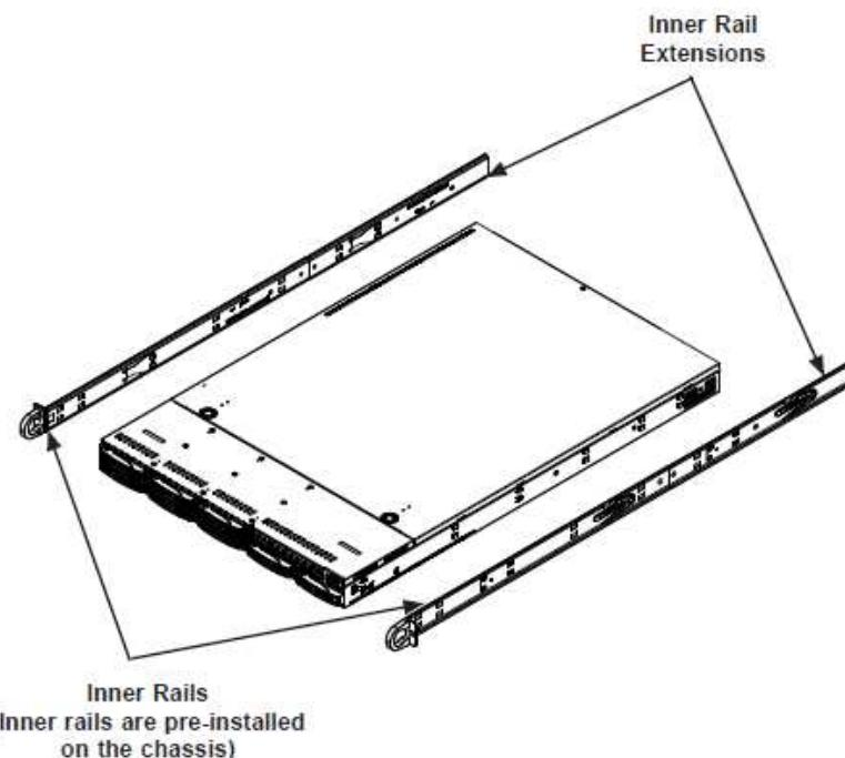
「Inner Rail」には「Locking Lever」がありラック内でシャーシをロックするとともに、シャーシを引き出した際にもシャーシをロックします。左右レールでロック解除方向が異なりますので留意ください。
