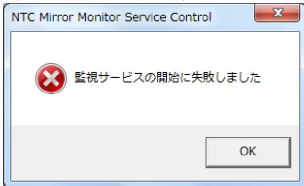
監視サービスが起動しているか、正しい権限を持っているか、インストールが正常に完了したか、などを確認して下さい。
