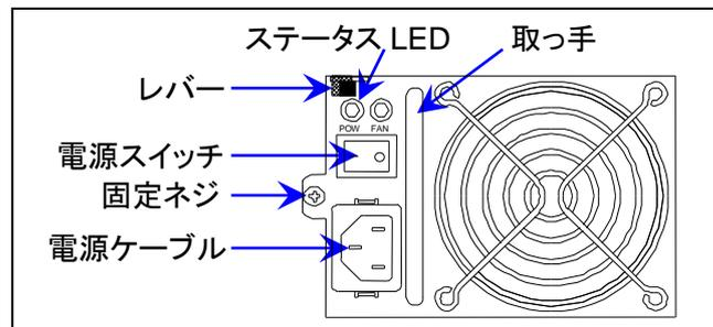
故障している電源が片方であれば、電源ユニットの交換はオンライン(稼働状態)のままで行えます。交換手順は下記のようになります。オフラインで交換の場合は、シャットダウン後に②で両方のユニットの電源スイッチをOFFにして、⑧で両方の電源スイッチをONにします。
