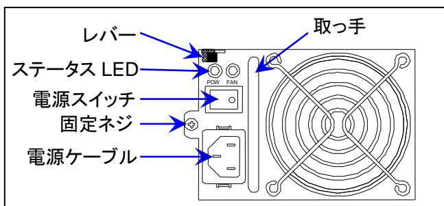
故障している電源が片方であれば、電源ユニットの交換はオンライン(稼働状態)のままで行えます。交換手順は下記のようになります。オフラインで交換の場合は、シャットダウン後に②で両方のユニットの電源スイッチを OFF にして、⑧で両方の電源スイッチを ON にします。
